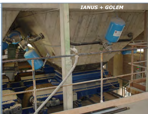
Con n.1 cannoni vengono asserviti n.4 punti di sparo With 1 cannons, 4 firing points are enslaved
